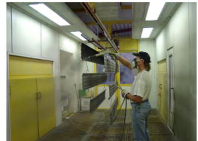
**Trockenspritzgeräte und Kabinen sowie wasserbeflutete Farbnebelabsauganlagen**
